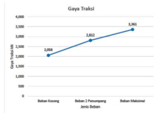
Gambar 4.3 Gaya traksi dengan beban 2 penumpang
