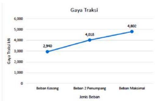
Gambar 4.2 Gaya Traksi dengan beban tanpa penumpang
