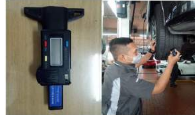
Gambar 3.2 Tyre Tread Depth dan Pengukuran Kedalaman Alur Ban
